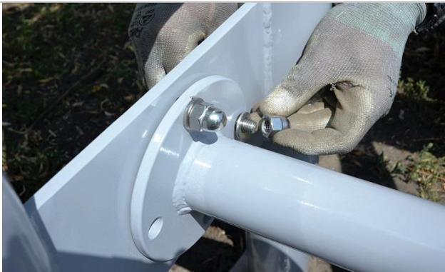
8. Una vez montado provisionalmente el dispositivo, inserte los tres tornillos restantes.
