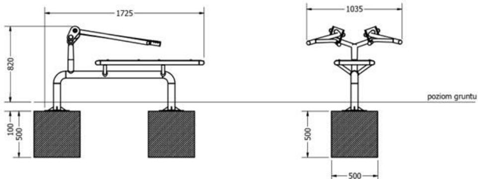
Fundament 100mm poniżej poziomu gruntu.
